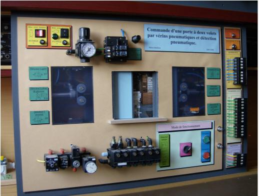
$\underline{\text{Mise en situation } n^\circ 9}$  : Unité de mise en mouvement de portes de magasin.
