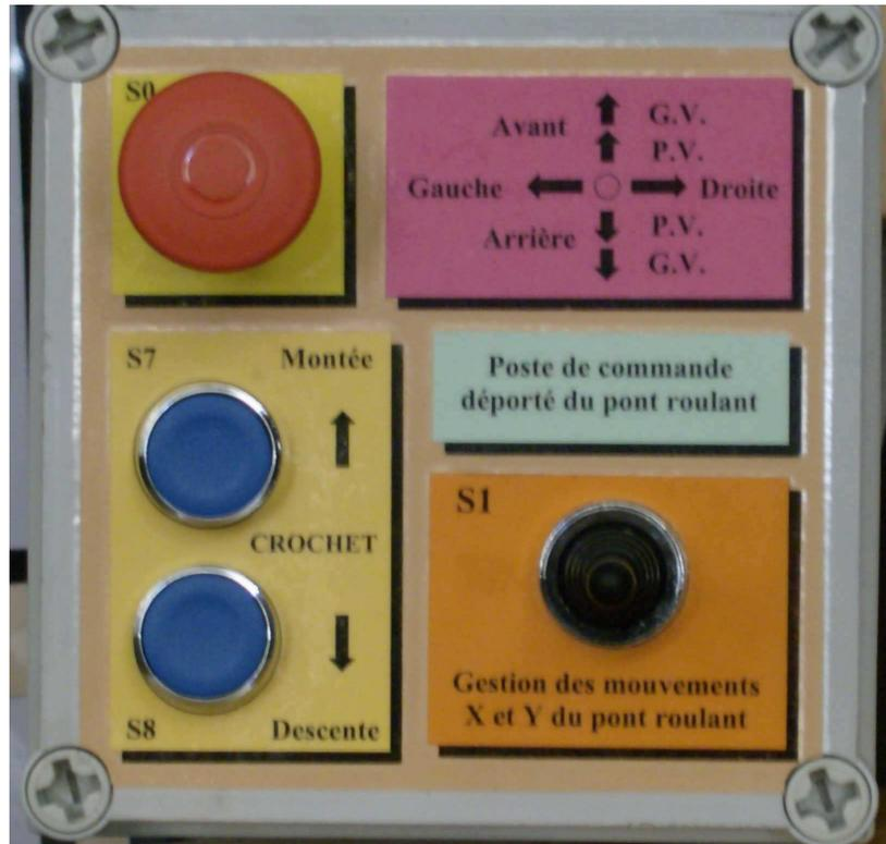
Comme c'est généralement le cas sur un pont roulant de type industriel, les différentes commandes de ce dernier sont déportées sur un boîtier extérieur. Ce boîtier contient toutes les commandes électriques nécessaires pour assurer le déplacement du pont suivant les axe « X », « Y » et « Z ».
