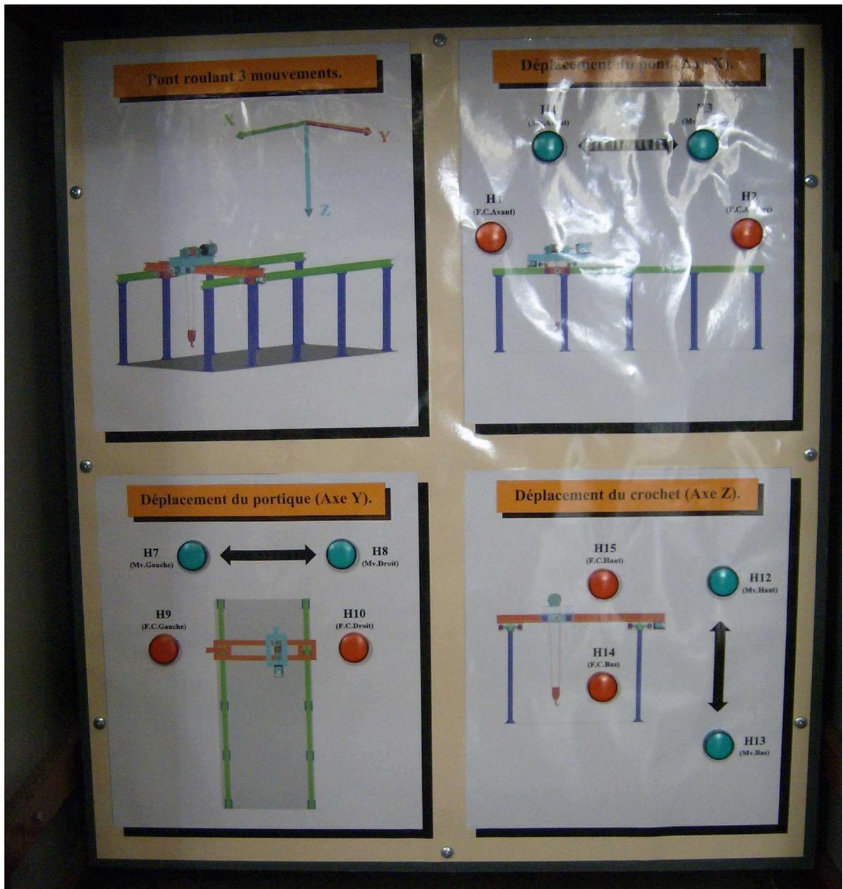
Panneau de simulation sous forme réduite. Ce panneau purement didactique a pour principal objectif de simuler le fonctionnement normal d'un pont roulant de type industriel.
